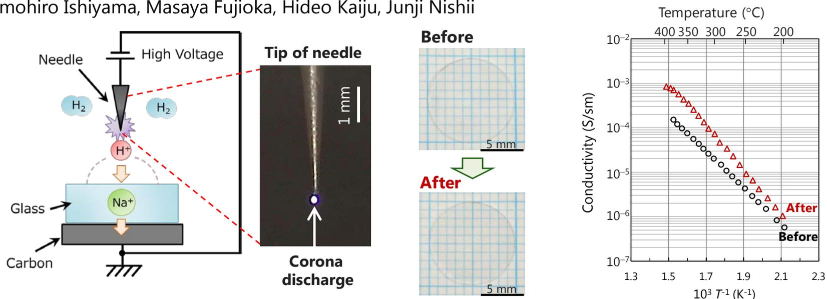
リン酸塩ガラス中のプロトンは移動度が高いことで知られているが、その濃度を高くすることが困難であった。本研究では、コロナ導電によって生成したプロトンを、電圧勾配を利用してリン酸塩ガラス中のNa<sup>+</sup>と置換することに成功し、約10<sup>-3</sup> S/cmのプロトン伝導度を達成した。
