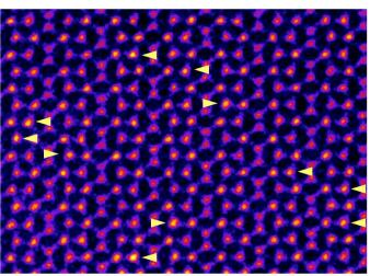
近年、金属酸化物やグラフェンなどの異なるプラットフォームとした単原子触媒が新規不均一系触媒として注目されている。本研究では、複雑な構造をとる金属間化合物 $Al_{13}$ Fe $_4$ の特定なFe原子サイトをPt原子で置換し、単原子分散することに成功した。単原子分散により金属間化合物の物性をチューニングすることが期待される。
